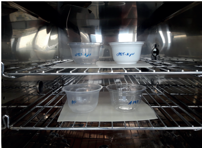
Bild 5. Vergleich der geprüften Muster vor und nach 30 Minuten Ofentest bei 100 °C © Illig
