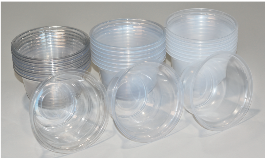
Ziemlich transparent: Drei Werkstoffe traten im Praxistest gegeneinander an. Links im Bild APET, in der Mitte CPET-light und rechts im Bild PP © Illig
